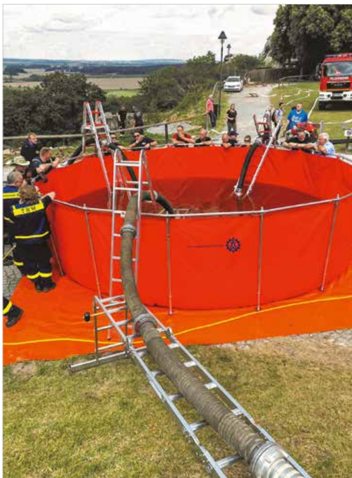
Mehrere Pufferbecken kamen zum Einsatz um das Wasser über eine Höhe von 100 Metern auf den Regenstein zu pumpen.
