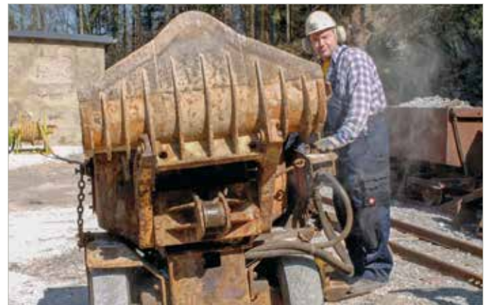
Er war zwar laut, erleichterte die Arbeit aber enorm: Jens Kruse vom Bergverein setzt den druckluftgetriebenen Bunkerlader in Betrieb.
